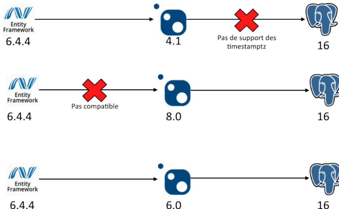
Fig. 8. – Problématique d’incompatibilité entre les différents éléments permettant au serveur et à la BDD d’échanger des informations.
